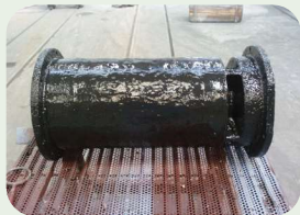
ripristino di superfici fortemente deteriorate
