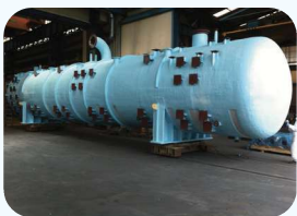
sistemi di coibentazione e protezione dal fuoco per serbatoi
