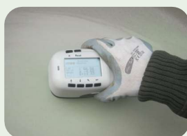
verifica riflettanza dei serbatoi
