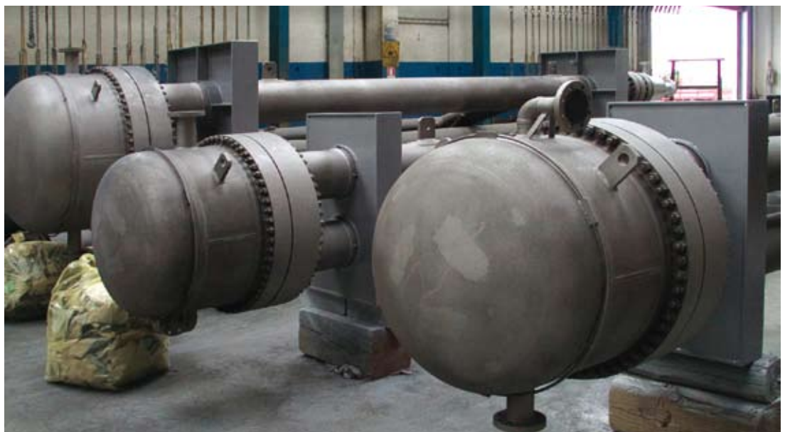
11 - Strutture metalliche granigliate pronte per i trattamenti protettivi polifunzionali.
