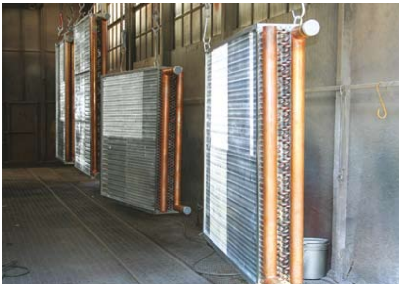
15 - I pacchi alettati, dopo la preparazione dei supporti, sulla linea di pitturazione anticorrosiva.
