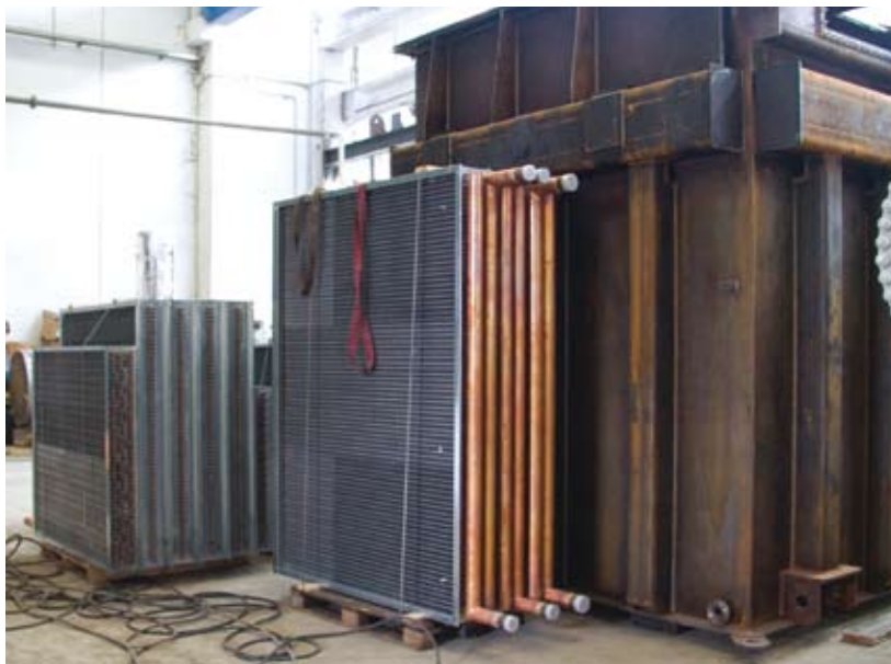
14 - Vista generale di alcuni pacchi alettati per evaporazione e refrigerazione prima della preparazione di sabbiatura con abrasivi non silicotigeni.
