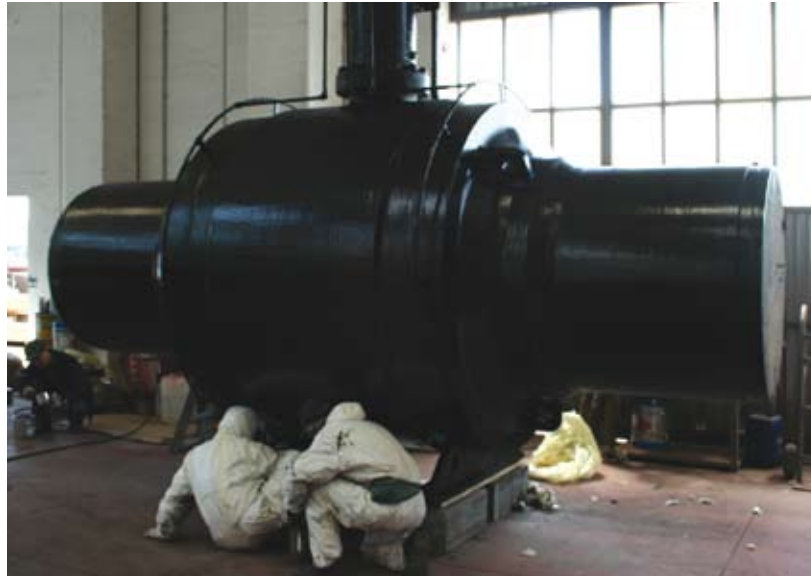
10 - Alcuni operatori al ritocco di aree protette (ma con film di basso spessore), dopo il loro controllo qualitativo, che deve superare i 1500 \mu\text{m} in ogni parte.
