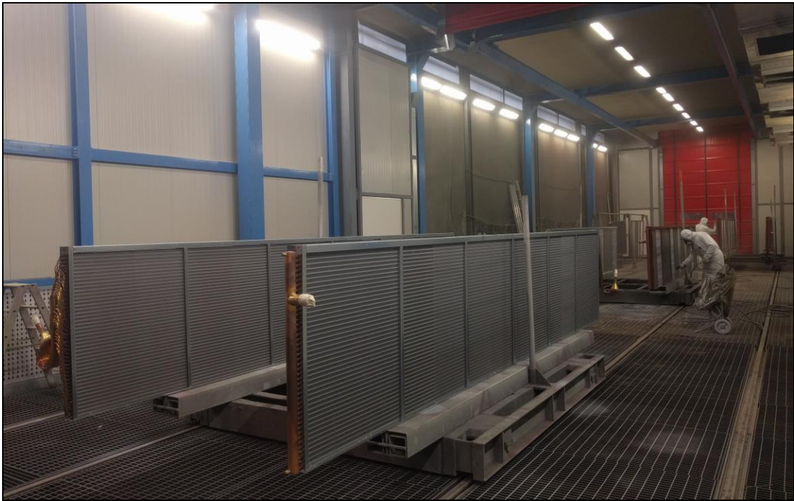
Batterie in cabina di verniciatura durante l'applicazione del primer sul casing.
