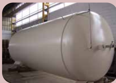
revêtement extérieur e réservoirs
