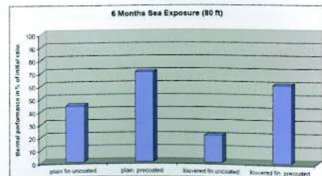
FIG. 5 Confronto tra alette non verniciate e pre-verniciate.
