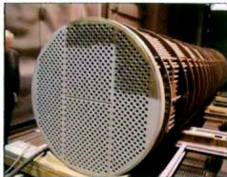
FIG. 19-20 Fase di sabbiatura dello scambiatore. Heat exchanger tube-bundle blasting.
