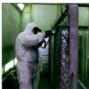
FIG. 7-8 Applicazione in stabilimento su scambiatore alettato.
