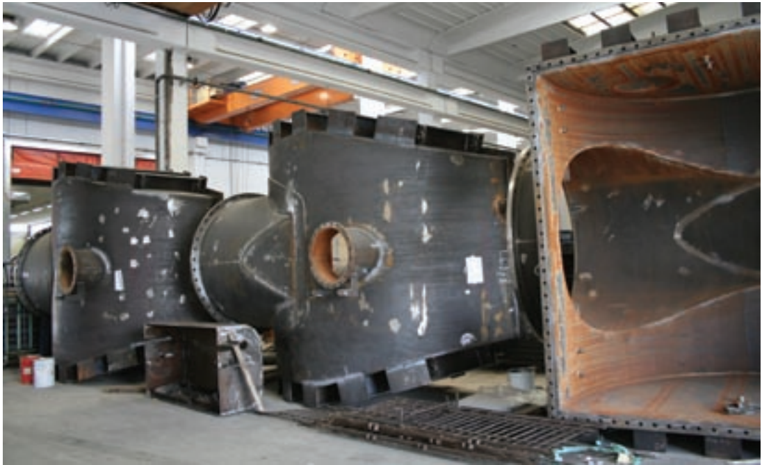
Fig. 2 - Le casse acqua del nuovo condensatore della centrale Tirreno Power di Vado Ligure (SV) in attesa di trattamento anticorrosivo
