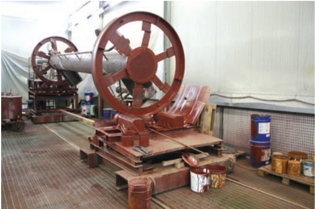
Fig. 11 - Uno scambiatore di calore durante l'applicazione del rivestimento con tecnologia Säkaphen
