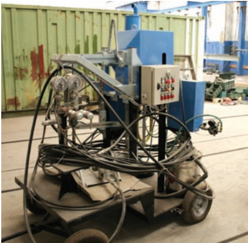
Fig. 10 - L'apparecchiatura Bimixer di spruzzatura di pittura vinilesteri, senza solventi e ad alto solido
