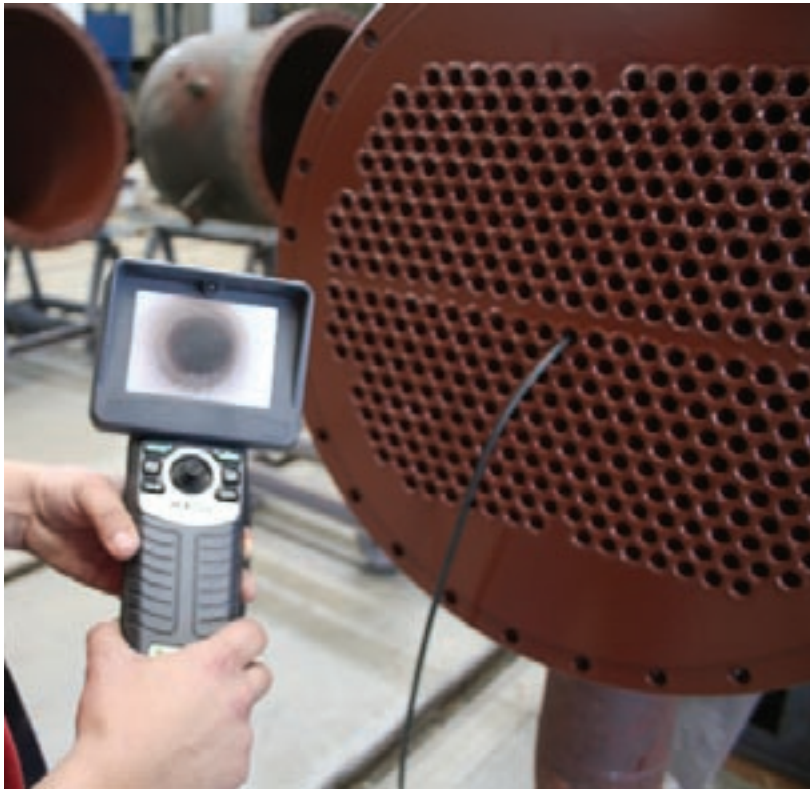
Fig. 15 - Il videoendoscopio a fibre ottiche per il controllo qualitativo del rivestimento interno degli scambiatori di calore
