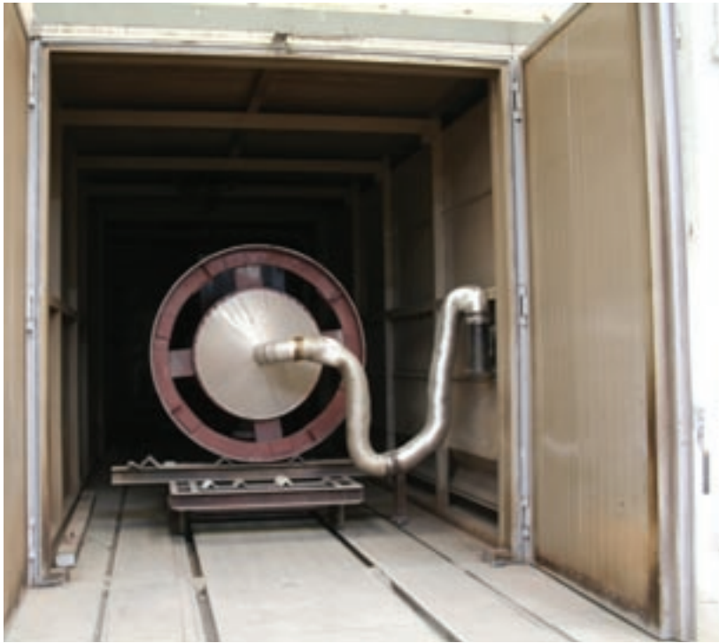
Fig. 12 - Il raffreddamento dello scambiatore dopo la polimerizzazione
