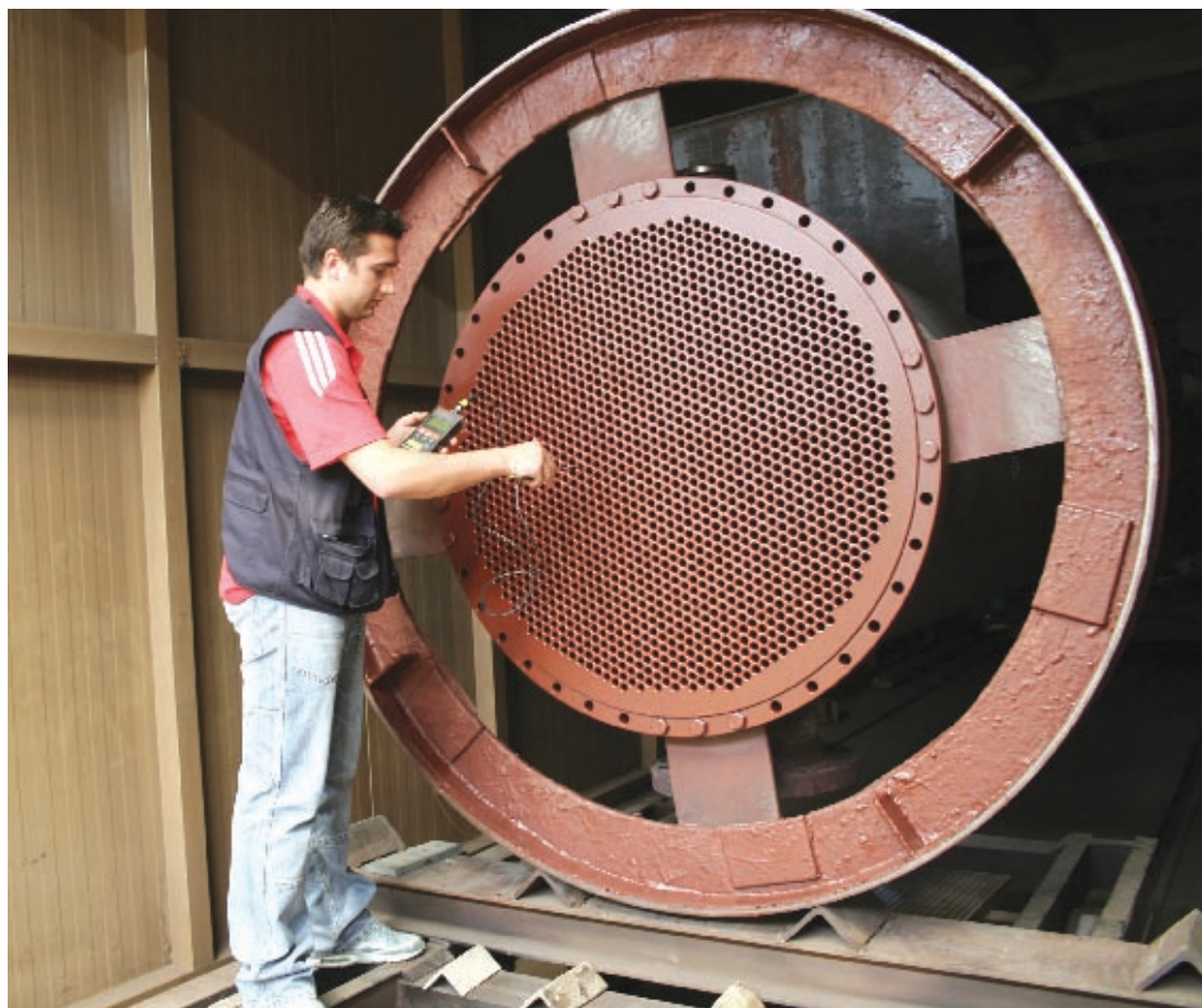
Fig. 14 - Il direttore di produzione Alessio Trisolino mentre effettua alcuni controlli qualitativi sul rivestimento interno dello scambiatore
