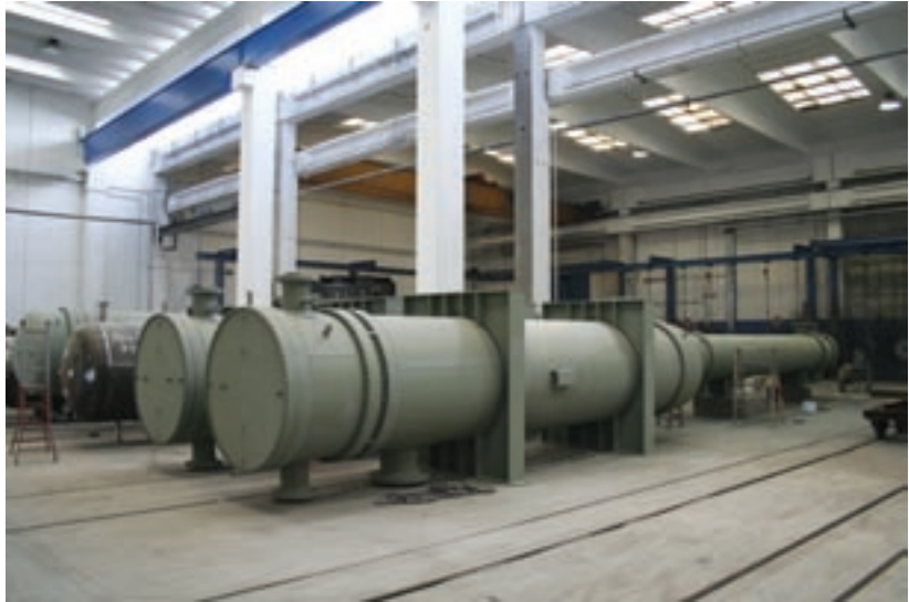
Figg. 3 e 4 - Gli scambiatori di calore rivestiti internamente dalla Alexo con tecnologia Säkaphen: all'esterno le superfici metalliche sono rivestite con zincanti inorganici prima della consegna all'utente
