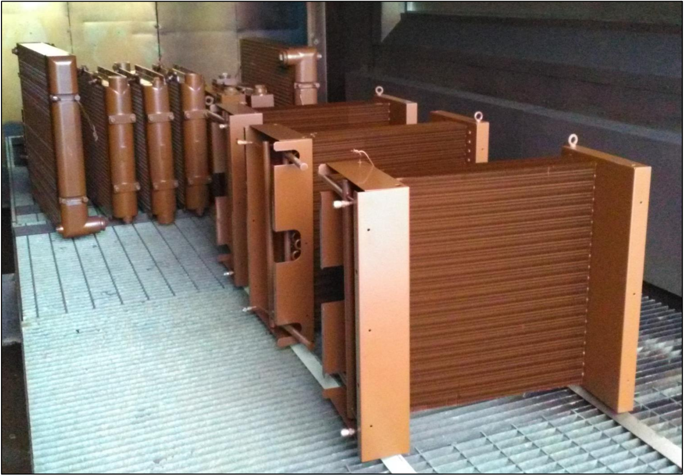
Echangeurs de chaleur à ailettes et micro-canal pendant la production.
